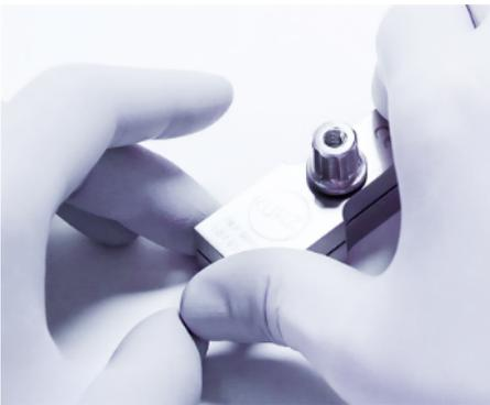
2. Den oberen Teil des Schneideblock drehen, bis er deckungsgleich auf dem unteren Teil liegt. Die Mutter festdrehen, um den Schneideblock in dieser Position zu fixieren.
