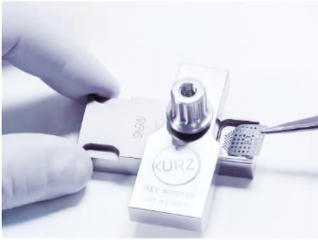
2. Die Distanzscheibe 1 mm in die Aussparung im unteren Teil des Schneideblocks legen.
