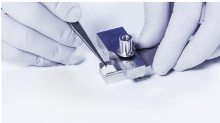
5. Den Schneideblock hinlegen, die Mutter lösen und den oberen Teil des Schneideblocks um 90° verdrehen.
