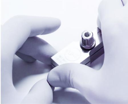
4. Den oberen Teil des Schneideblock drehen, bis er deckungsgleich auf dem unteren Teil liegt. Die Mutter festdrehen, um den Schneideblock in dieser Position zu fixieren und die Faszie zu pressen.
